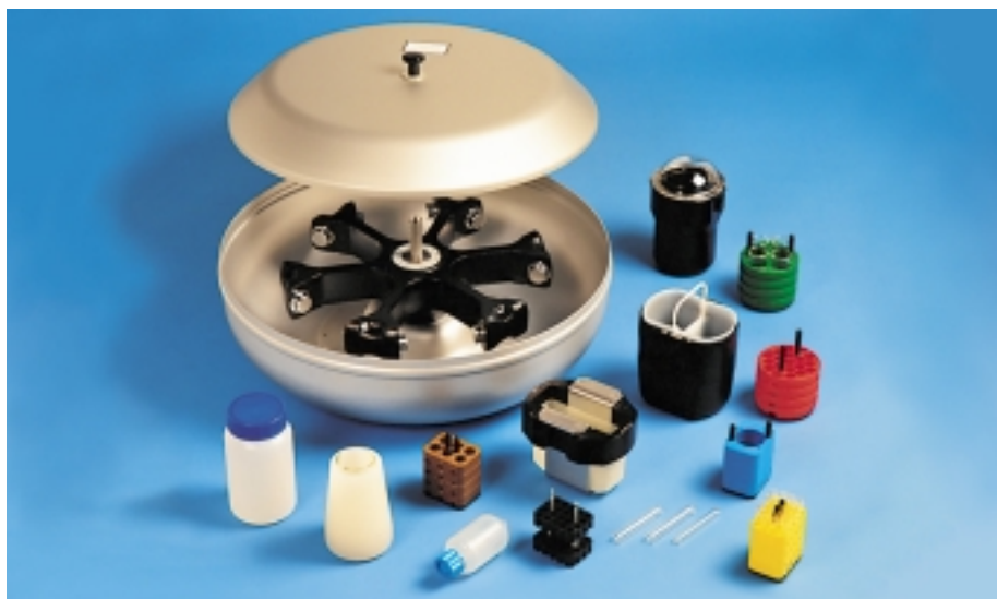
Rotor caréné avec couvercle, 6 différents modèles de godets et adaptateurs correspondants
