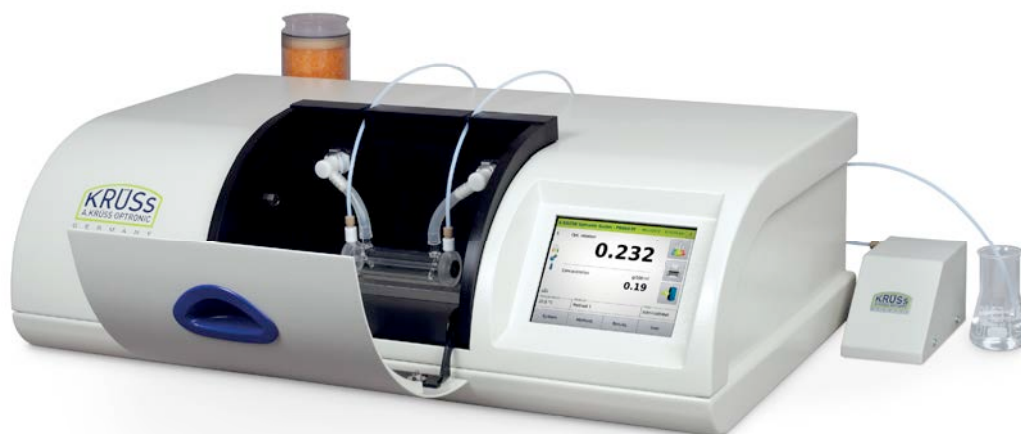
Introduction semi-automatique des échantillons avec P8000-TF et pompe péristaltique DS7070
